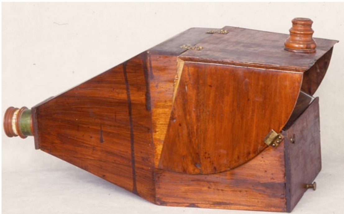
Figura 21 - Camera oscura portatile (XVIII secolo) secondo il modello di J. Zahn del 1685.
