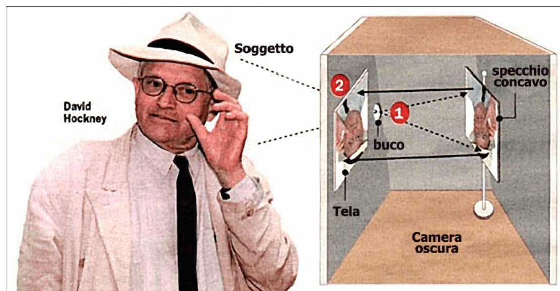
Figura 19 - La camera oscura dotata di lente e specchio concavo secondo lo schema di Hockney (2001).
