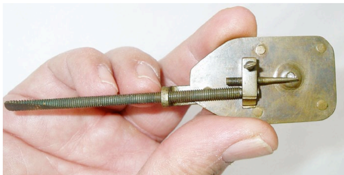
Figura 32 - Microscopio "a perlina" di A. van Leeuwenhoek (1676?).
